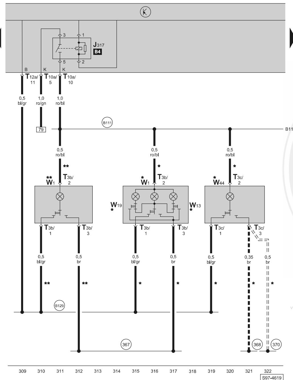
vnitřní osvětlení vpředu, čtecí lampička vzadu, relé napájecího napětí (30)
