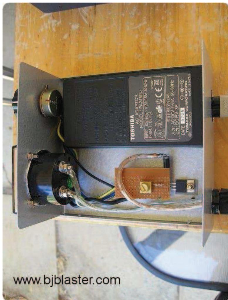
Starý notebook napájení je 15V @ 3A - takže se můžete dostat kolem 4A z toho před tím, než jde do tepelné vypnutí. Tento zdroj pak krmí FET regulátoru, takže si můžete nastavit zatížení jít do banky baterie.
