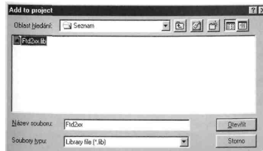
Obr. 5.16 Připojení importní knihovny do projektu
