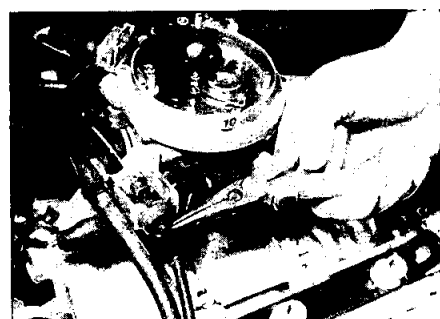
obr. 4.7b Táhlo seřídíme nasazením pojistného kroužku do jedné z drážek na pouzdru táhla
