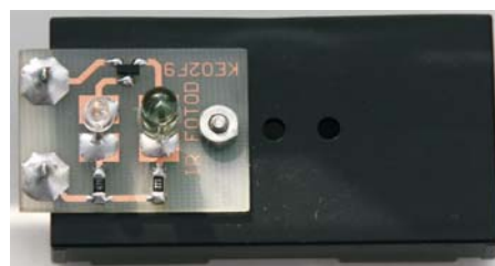
Obr. 8. Sestavený minitester IR dálkových ovladačů
